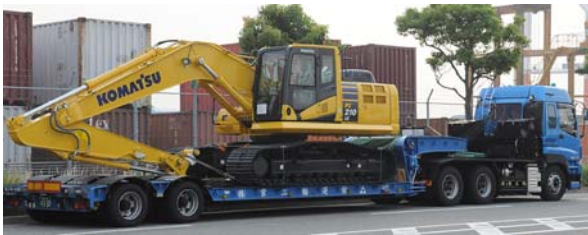
図-3 大型低床トレーラによる輸送
