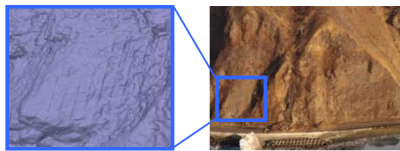
図-4 岩盤斜面金網部の地形モデル化例
