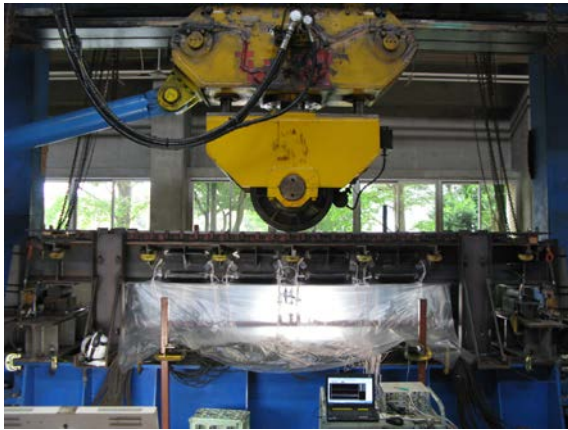
写真-4 移動荷重疲労試験状況
