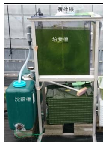
図-2 密閉縦型培養槽
