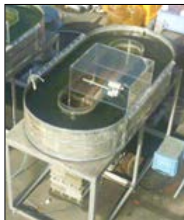
図-1 上部開放レースウェイ型培養槽
