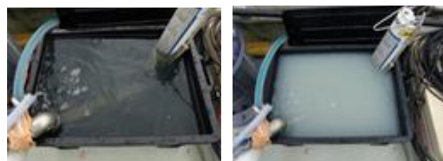
写真-2 実験時の試験水の様子 (左：実験開始時、右：酸素供給 120 分後)
