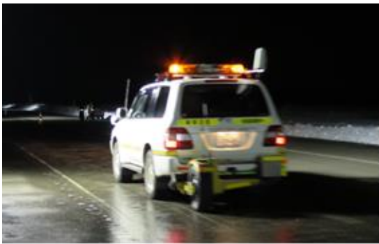
写真-5 散布試験実施状況 (すべり抵抗値測定)
