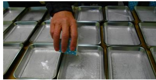
写真-1 融氷量試験実施状況（試料散布）
