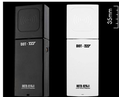
写真-2 読取装置（UHF 帯リーダ）
