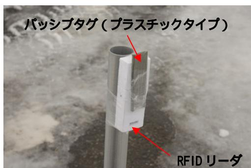
写真-5 RFID タグ（アクティブタグの模擬型）
