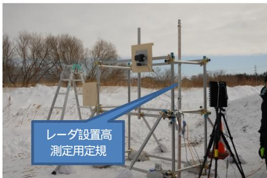
写真-9 ミリ波レーダ設置状況
