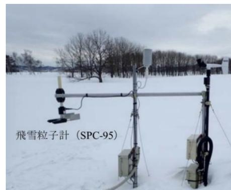
図 15 基準点 (No.0) に設置した飛雪粒子計
