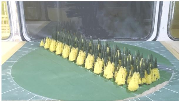
図 18 風洞実験装置のターンテーブルと防雪林模型
