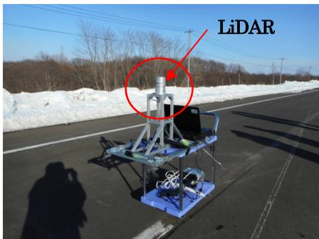
写真-8 LiDARによる自車位置測位状況
