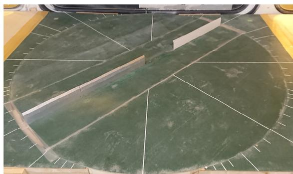
図 - 17 実験装置のターンテーブルと製作した防雪柵模型
