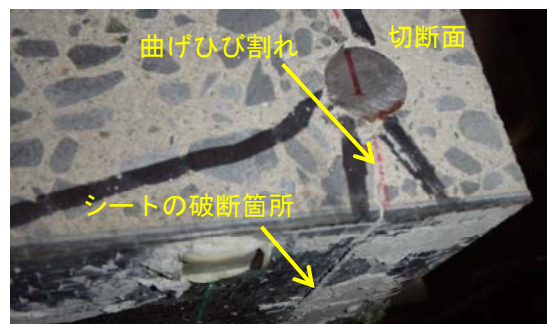
写真-2 CF1のシート破断
