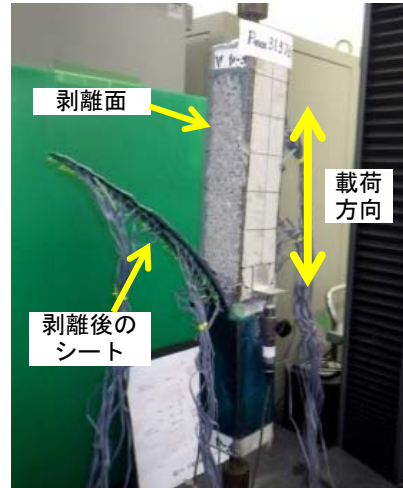
写真-4 付着試験におけるシートの剥離状況
