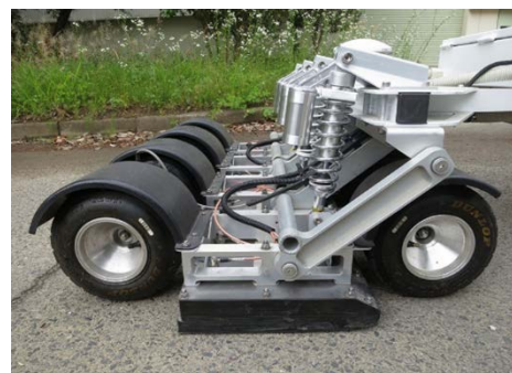
図3-2 車両牽引型多チャンネルGPR
