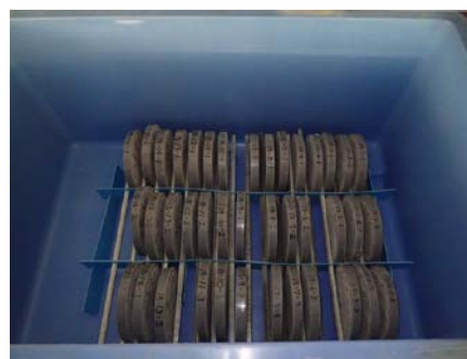
図 2-2 浸せき試験時の試験片設置状況
