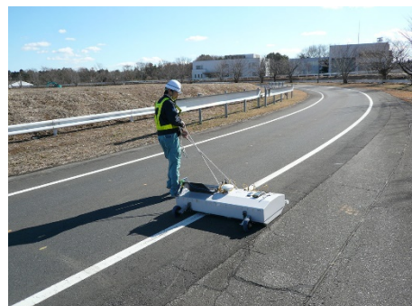
図3-1 ハンディ型多チャンネルGPR
