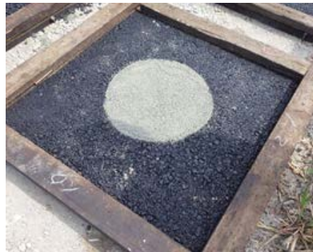
写真3-3 模擬層間剥離作成
