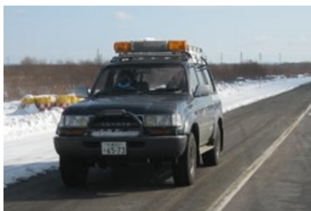
図5-1 IRI 計測装置搭載車両
