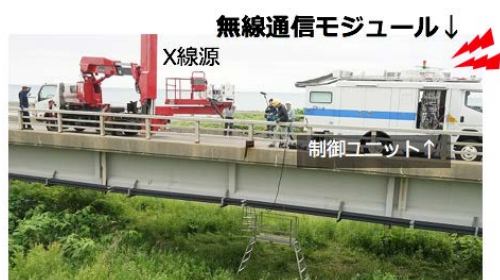
図-2.6 電源用車両を活用した撮像体系
