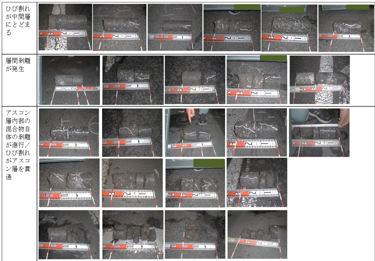
図2-2 コア抜き調査結果
