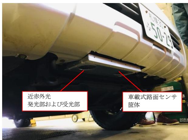
図2 車載式路面センサ
