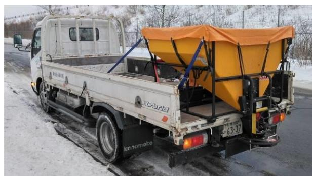
写真-8 車載式凍結防止剤散布装置
