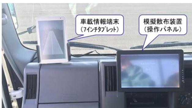
写真-2 試験車両の助手席付近に設置した各機器
