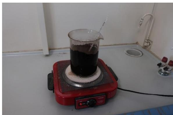
写真-4 前処理作業 (泥炭土試料に 0.1M 水酸化ナトリウム溶液を加え、沸騰状態に加熱し攪拌)
