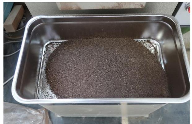
写真-2 北村遊水地泥炭土を乾燥粉碎した土試料
