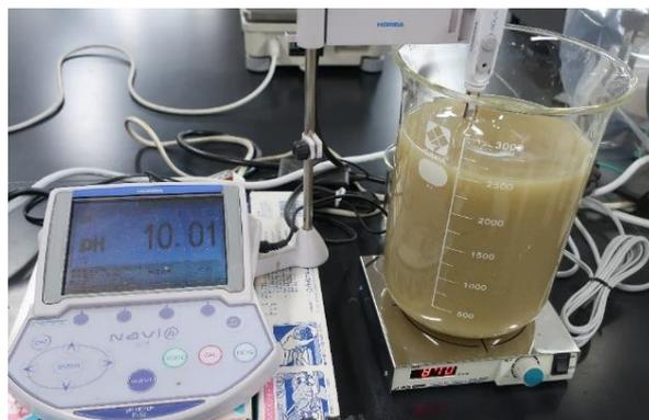
写真-8 TEMPO触媒酸化作業 (0.5M水酸化ナトリウム溶液を随時注入し、pH10以上を保持)
