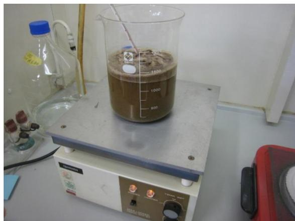
写真-3 リグニン除去作業 (70~80°Cに加熱し攪拌)
