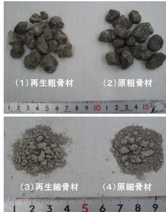
写真-1 再生骨材と原骨材
