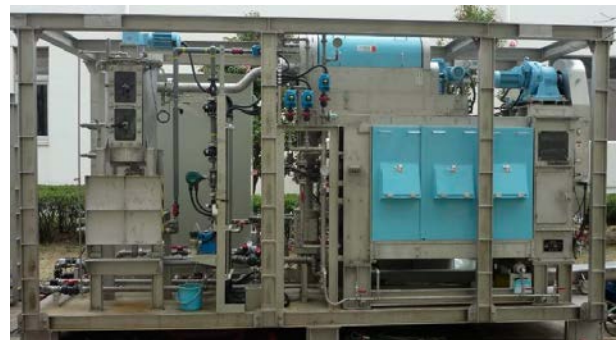
図-6 圧入式スクリープレス脱水機 (脱水部スクリーン径 φ300 mm)
