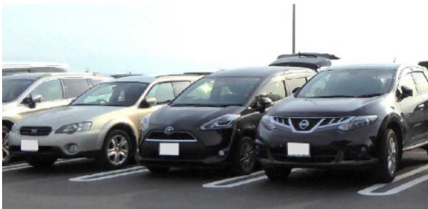
写真-7 車両の大型化によりこれまでの基準では狭くなっている「道の駅」の駐車マス
