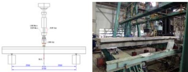
図-2.2 疲労・静的载荷試験の装置図と外観
