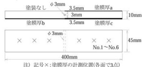
図-3.4 塗装試験体の寸法形状
