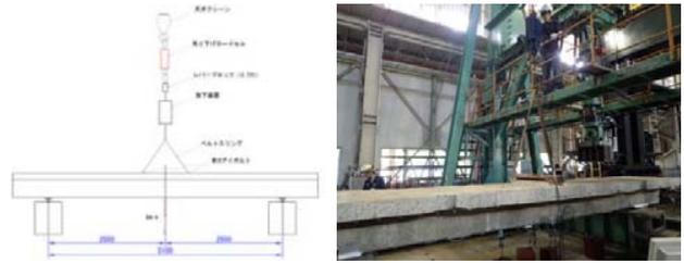
図-2.3 加振試験の装置図と外観
