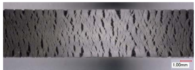
図-2.4 試験終了後の供試体外観 (条件 C : オゾン濃度 10pphm、与ひずみ 50%)
