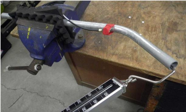
写真-3 照明柱モデルでの計測状況
