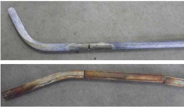
写真-4 照明柱劣化モデル（上：亀裂、下：腐食）
