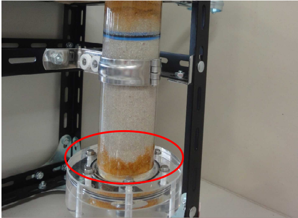
写真-4 カラムの最下部に発生した赤褐色沈殿物 (酸性水 9,000mL 通水終了後に撮影)
