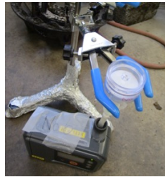
写真-4 作業場近傍の フィルタ設置状況
