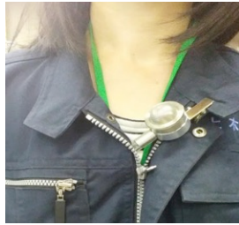
写真-3 作業員用フィルタ
