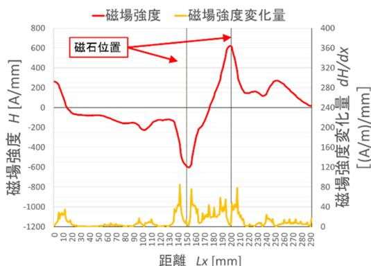
図-26 磁場強度と変化量(Z方向(深さ))
