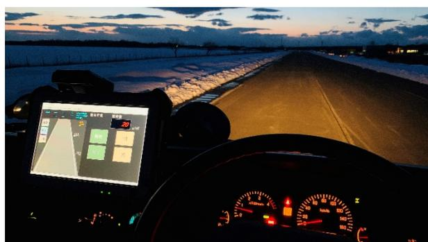
写真-14 運転席付近に設置した車載タブレットPC
