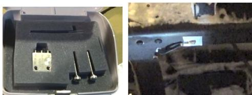
図-69 加速度ピックと設置状況
