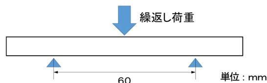
図-31 荷重点（曲げ試験）
