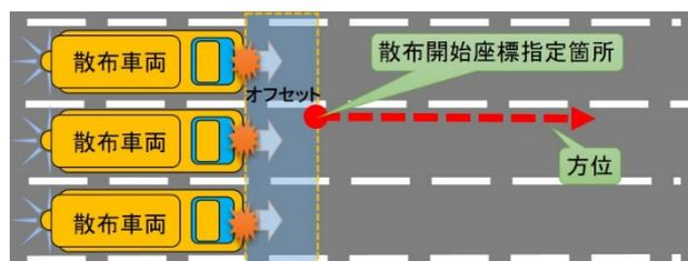
図-22 複数車線におけるオフセットの概念図
