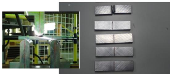
図-32 試験片（曲げ試験）
