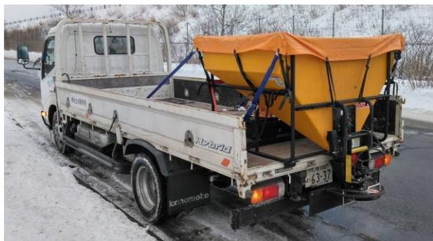
写真-8 車載式凍結防止剤散布装置
