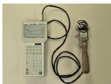
図-23 自己磁場測定型残留応力検出機
