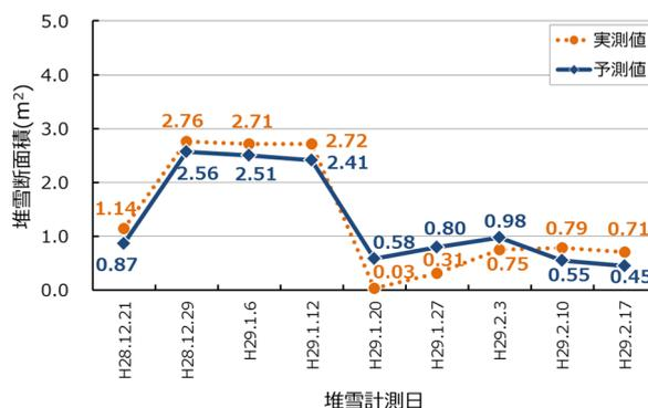
図-15 分類A累計②(車道部堆雪断面積)による比較例(H28、札幌 R5地点②)
