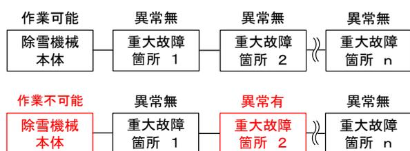
$$\text{信頼度 } R_s(t) = \text{信頼度 } R_1(t) \times \text{信頼度 } R_2(t) \times \dots \times \text{信頼度 } R_n(t)$$
