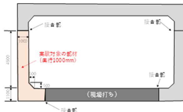
図-1 分割式カルバートの概要と供試体の寸法
