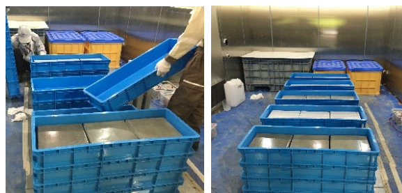
写真-3 室内促進劣化試験の状況
