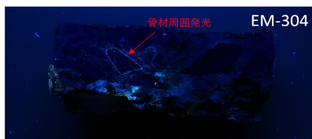
写真-3 ゲルフルオレッセンス法による確認結果
