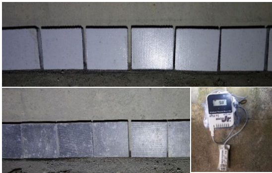
写真-4 屋外暴露試験の状況
