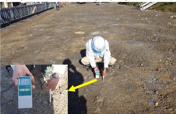
写真-19 盛土の含水比計測の状況
