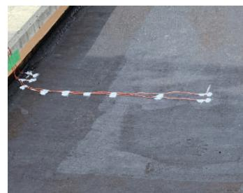
写真-10.4 模擬床版上の電極設置状況
