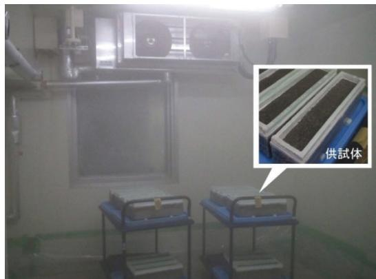
写真-3.1 凍結融解試験の様子
