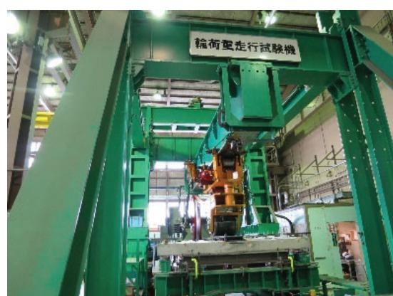
図-7.2 輪荷重走行試験機
