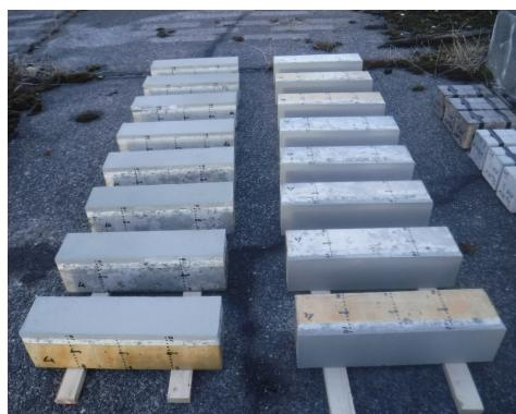
図-4.1 実験棟屋上での暴露試験状況
