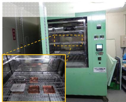
写真-2.4 凍結融解試験機の全景とその内部
