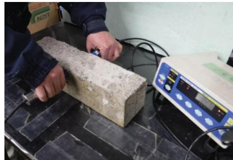
写真-5.4 超音波による相対動弾性係数の測定状況
