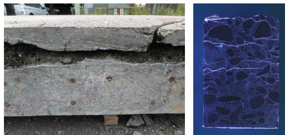
(a) 切断面 (b) 微細ひび割れ
