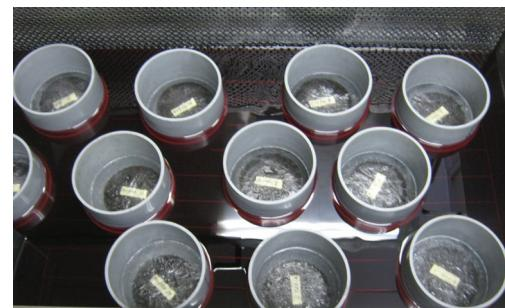
写真-2.3.1 円柱状供試体の凍結融解状況
