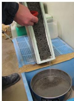
写真-4.2 スケーリング片の採取状況
