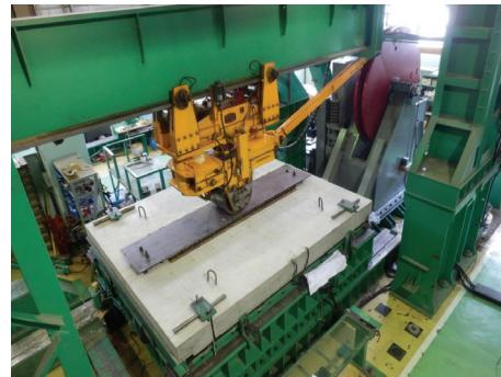
写真-14.1 輪荷重走行試験機
