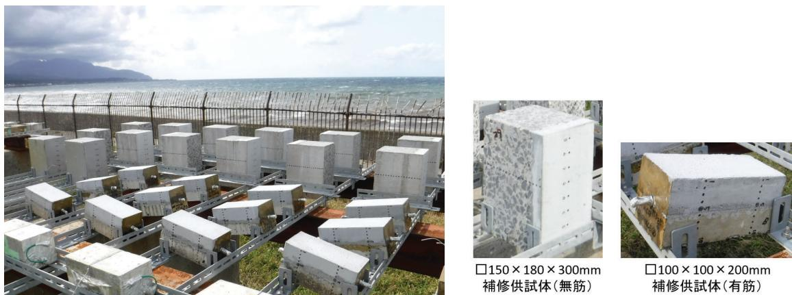
図-4.3 増毛暴露場での暴露試験状況と暴露供試体
