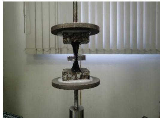
写真-6.2 引張接着力試験状況
