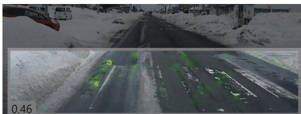
図-2.4.6 検出漏れの例(偽陰性、ポットホールを見落とし)
