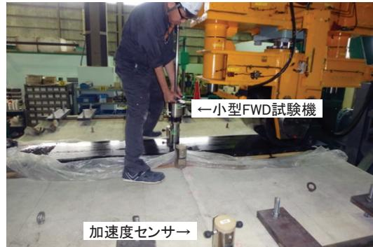
(b) 衝撃荷重載荷試験
