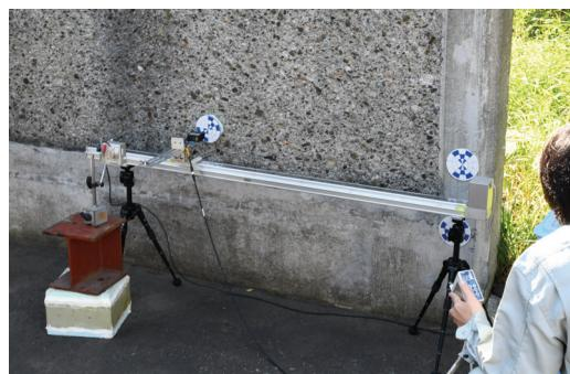
写真-2 測定状況（レーザー変位計）
