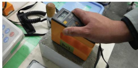
写真-4.2 高周波容量式の水分計による測定状況
