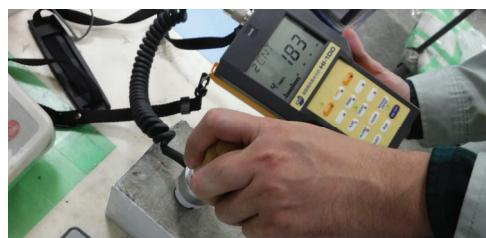
写真-4.3 電気抵抗式の水分計による測定状況
