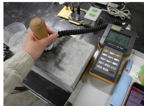
写真-6.7 電気抵抗式水分計による測定
