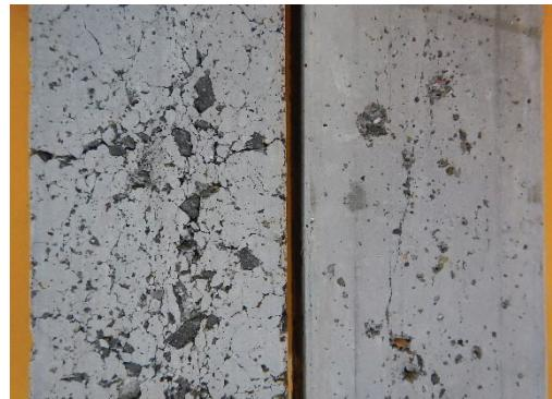
写真-3.1 凍結融解試験後の外観性状（真水）
