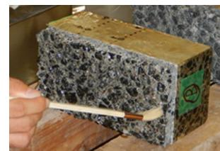
図-2.2 浸透系塗布材の塗布状況
