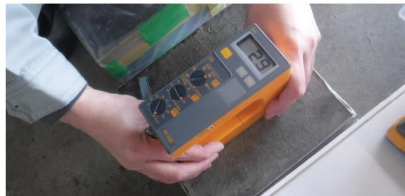
図-5.11 高周波容量式水分計による測定状況
