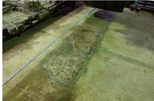
図-7.3 土砂化の状況 (S47 供試体, 26.5 万回時)
