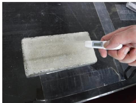
写真-4.4 表面温度の測定状況
