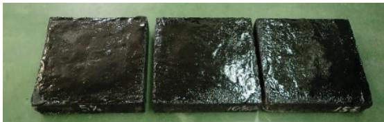
写真-6.7 IH加熱試験用供試体
