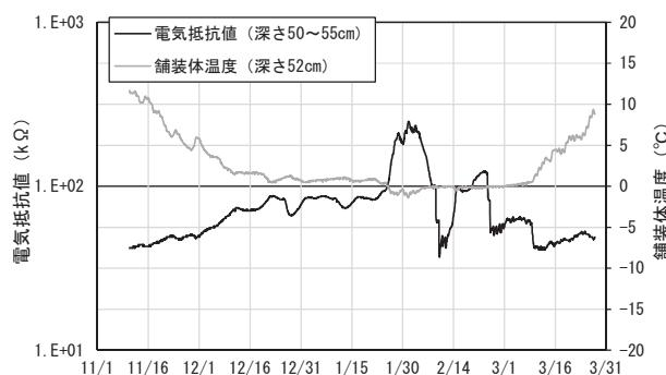
図-2.1.8 電気抵抗値の推移(凍上抑制層上面)
