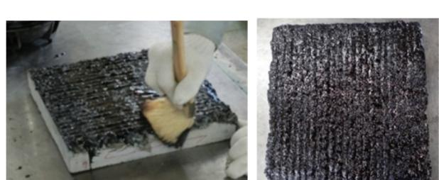
写真-4.2 防水材の塗布状況（標準）
