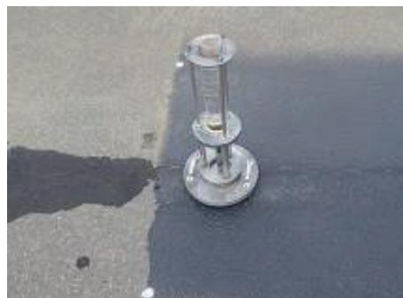
写真-3.4 現場透水試験による測定
