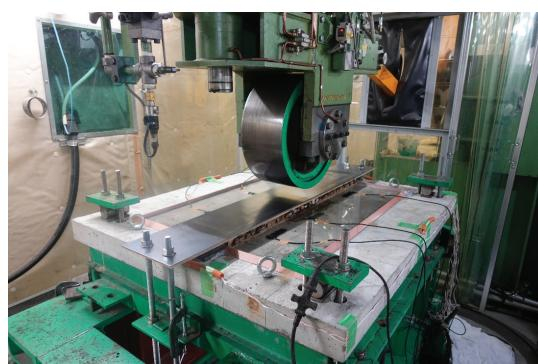
写真-8. 1 小型輪荷重走行試験機
