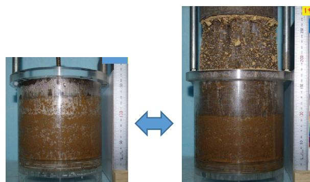
写真-3.1 凍上試験前後の供試体外観
