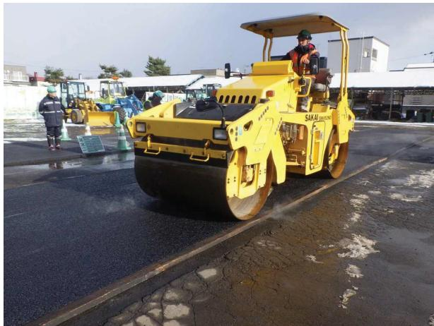
写真-2.2 水平振動ローラ (7t 級)
