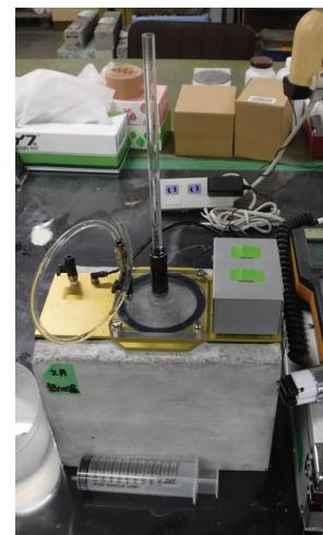
写真-6.5 真空ポンプで取り付ける仕様の透水試験機
