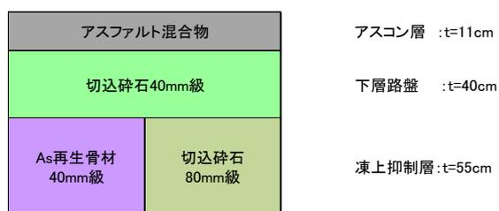
図-42 試験施工箇所の断面
