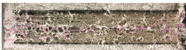
写真-1 ひび割れ率 20%時の混合物の表面状態
