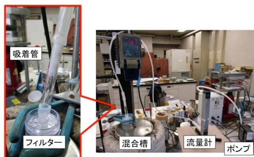
写真-1 アスファルトフェーム測定系の様子
