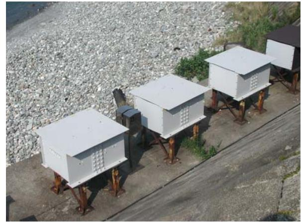
写真-4 補修塗装後の耐候性鋼橋梁模擬供試体
