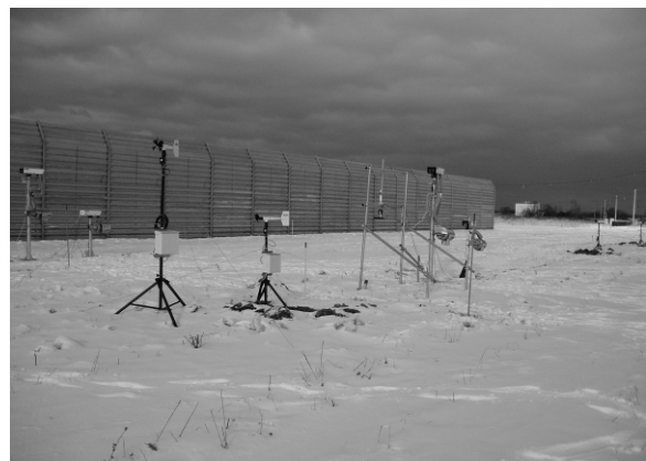
写真 1 防雪柵の防雪効果計測状況
