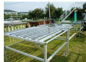
写真-1 薄膜暴露供試体
