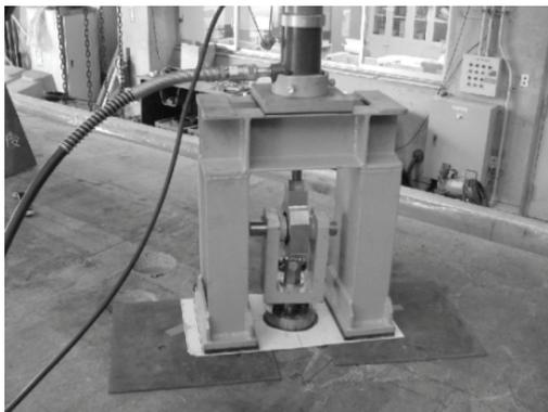
写真-1 付着強度試験機
