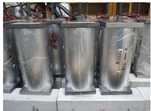
写真-2 シールによる被覆供試体
