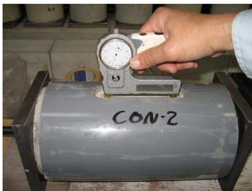
写真-1 塩ビ管で拘束した供試体 (Case7)
