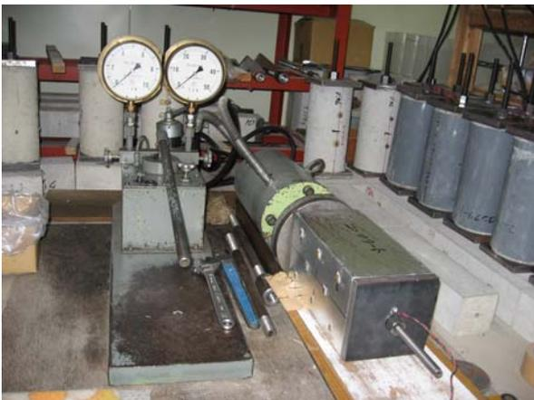
写真-3 角柱供試体のクリープ荷重状況 (Case8)
