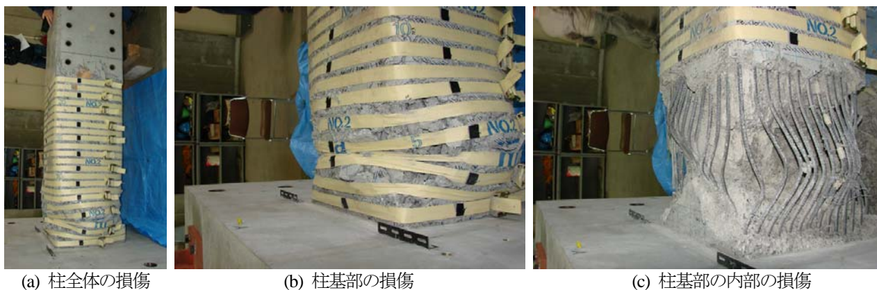
図-15 バンド補強模型の実験後の損傷状況
