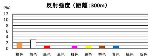
図-4 視認性確認試験時の T S の反射強度
