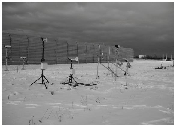
写真 1 防雪柵の防雪効果計測状況
