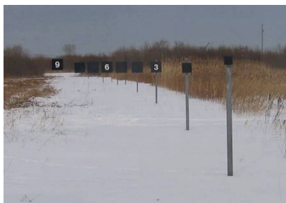
図1 視程板の設置状況
