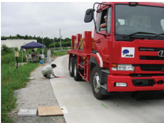
写真-3 静的載荷試験状況
