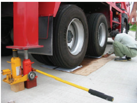
写真-2 タイヤ接地面積測定状況
