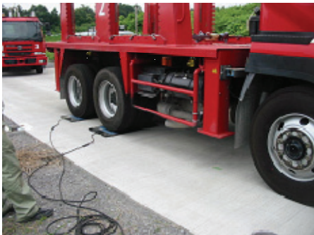
写真-1 輪荷重測定状況
