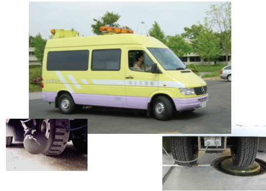
写真-5 舗装路面騒音測定車 (RAC 車)
