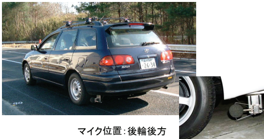
写真-4 タイヤ／路面騒音測定車(乗用車)
