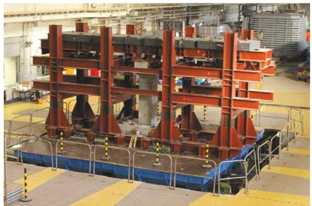
図-3 振動台実験状況
