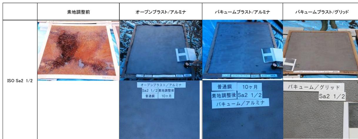
図-8 普通鋼材（暴露10ヶ月）のブラスト処理前後の状況
