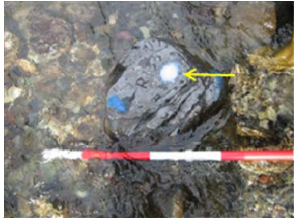
図-3.4 低周波発信器の埋め込み状況
