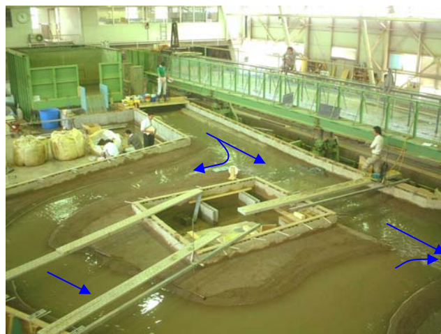
図 - 15.1.37 1/25 試験地抽出模型（予備実験）
