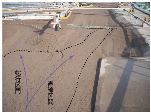
図 - 15.1.49 CASE2-2 通水後の旧川 J 分岐点における土砂堆積
