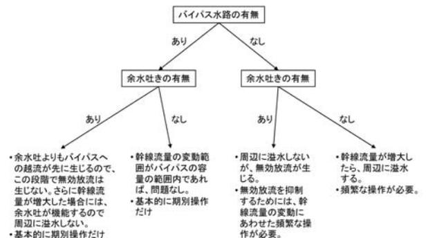
図-6 水位調整施設の管理労力と付帯構造物
