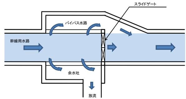
図-5 水位調整施設の形式例
