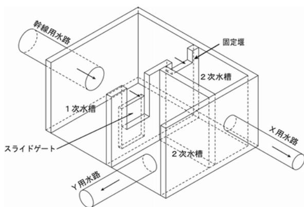
図-4 スライドゲートを用いた分水工の例
