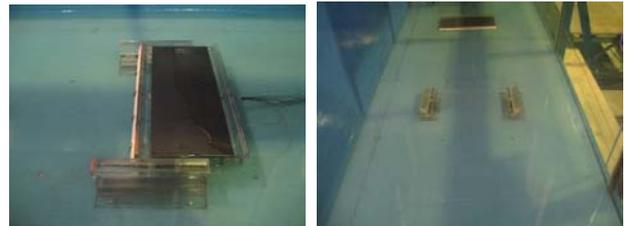
写真 3.2 RC 橋模型上部構造の挙動 (水深 3.0m)
