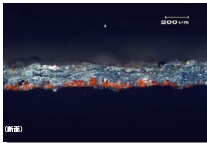
写真-15 溶射皮膜断面（茶色は粗面形成材）
