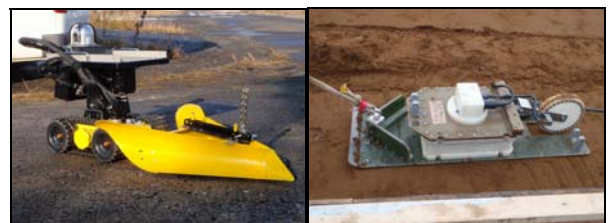
写真6 堆砂除去装置(左側)・空洞探査装置(右側)
