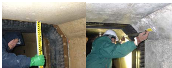
写真 11 沈下測定鉈の沈下量計測状況（左側）と継手変位測定鉈間の変位量計測状況（右側）
