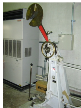
写真-2 シャルピー 衝撃試験機
