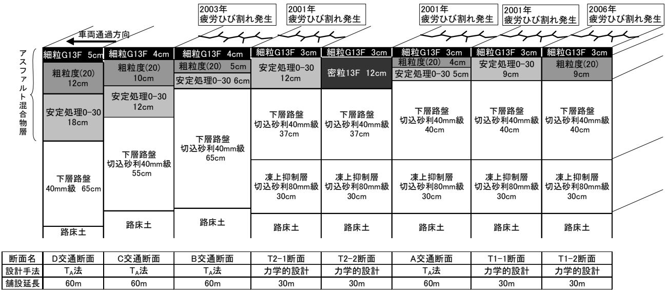
図26 美々試験道路の疲労ひび割れ発生状況
