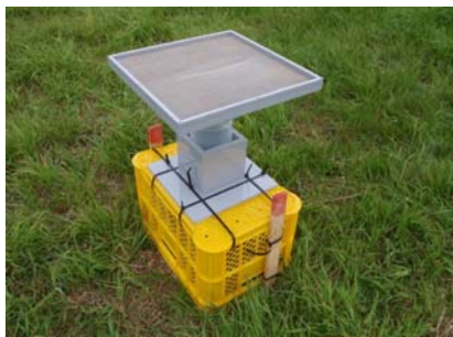
写真-1 雨水集水装置
