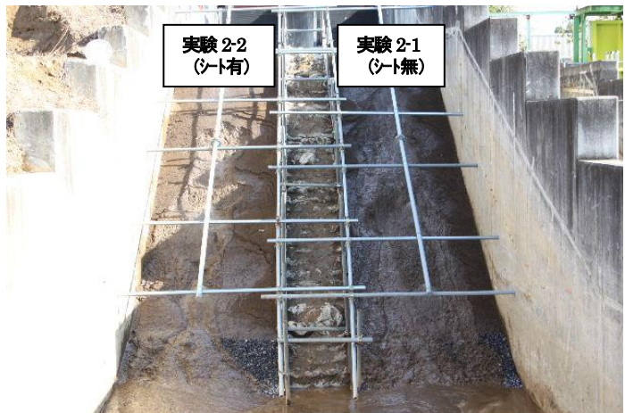
写真-3 堤防裏のり面状況比較 (30分降雨後)
