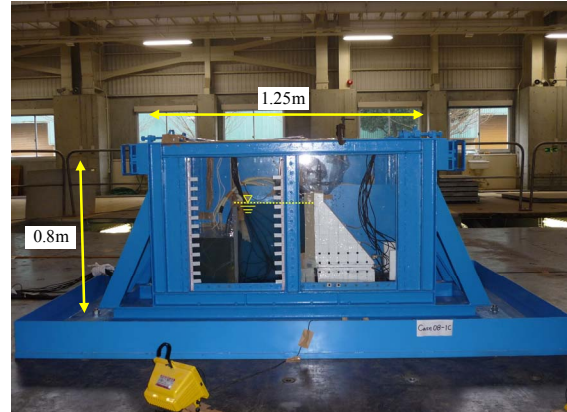
写真-2 試験体を設置した水槽
