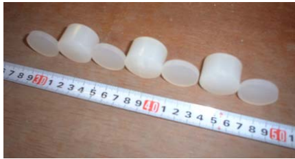
図-4.17 実験に用いた氷群模型
