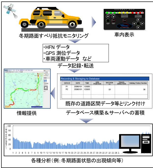
図-7 冬期路面すべり抵抗モニタリングシステムの概略
