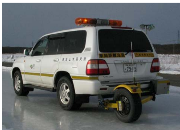
写真-1 連続路面すべり抵抗値測定装置 (CFT)
